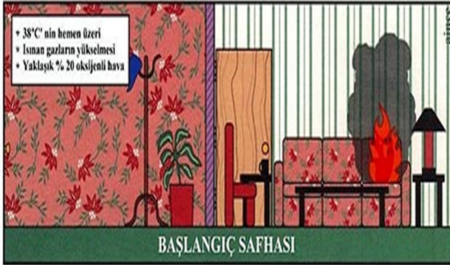
Şekil 6: Bir yangının ilk safhaları, yangının başlangıç safhası olarak değerlendirilir.
