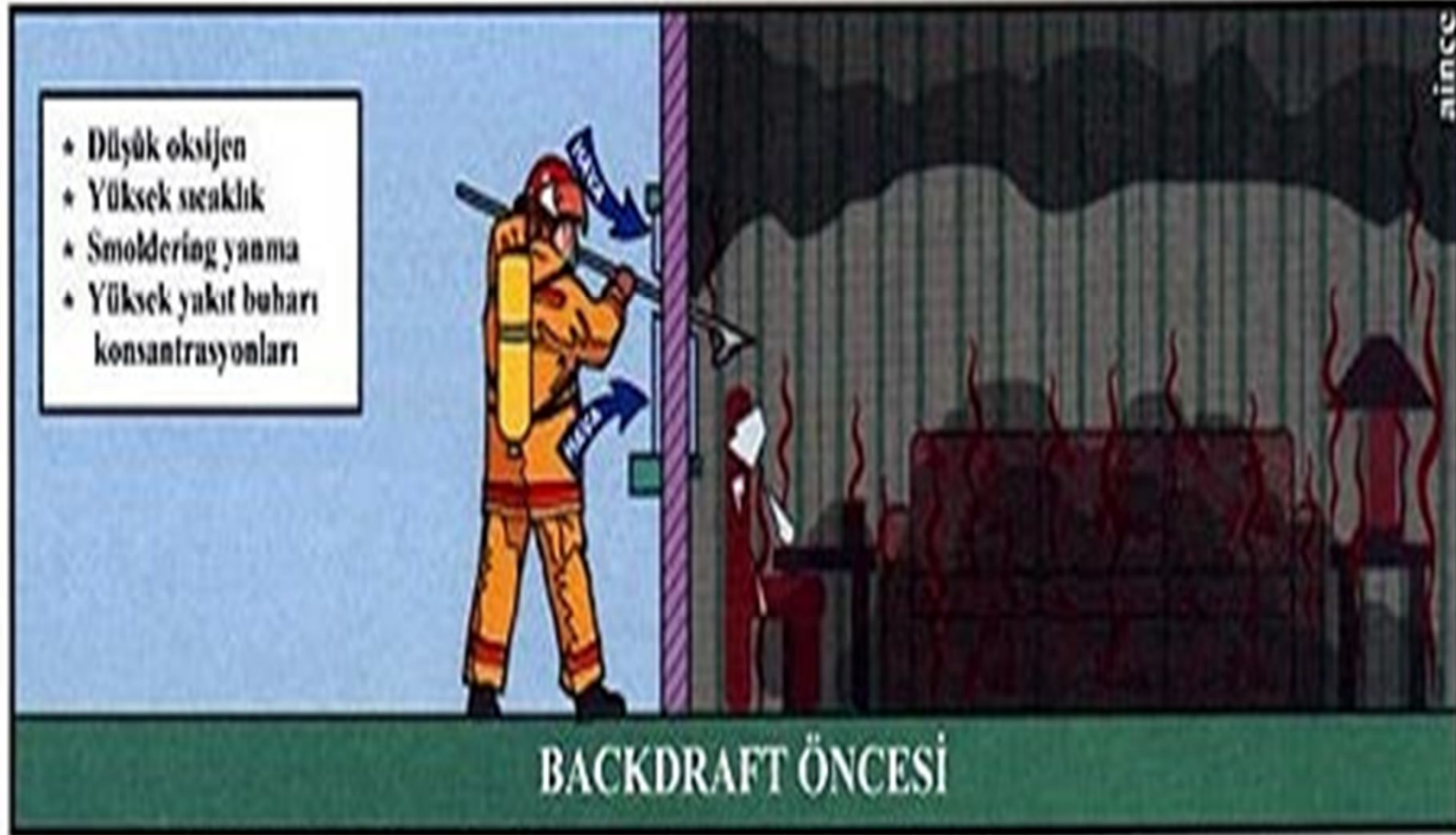
Şekil 12: Backdraft öncesinde yangının devamı için yetersiz oksijen ortamı söz konusudur.
