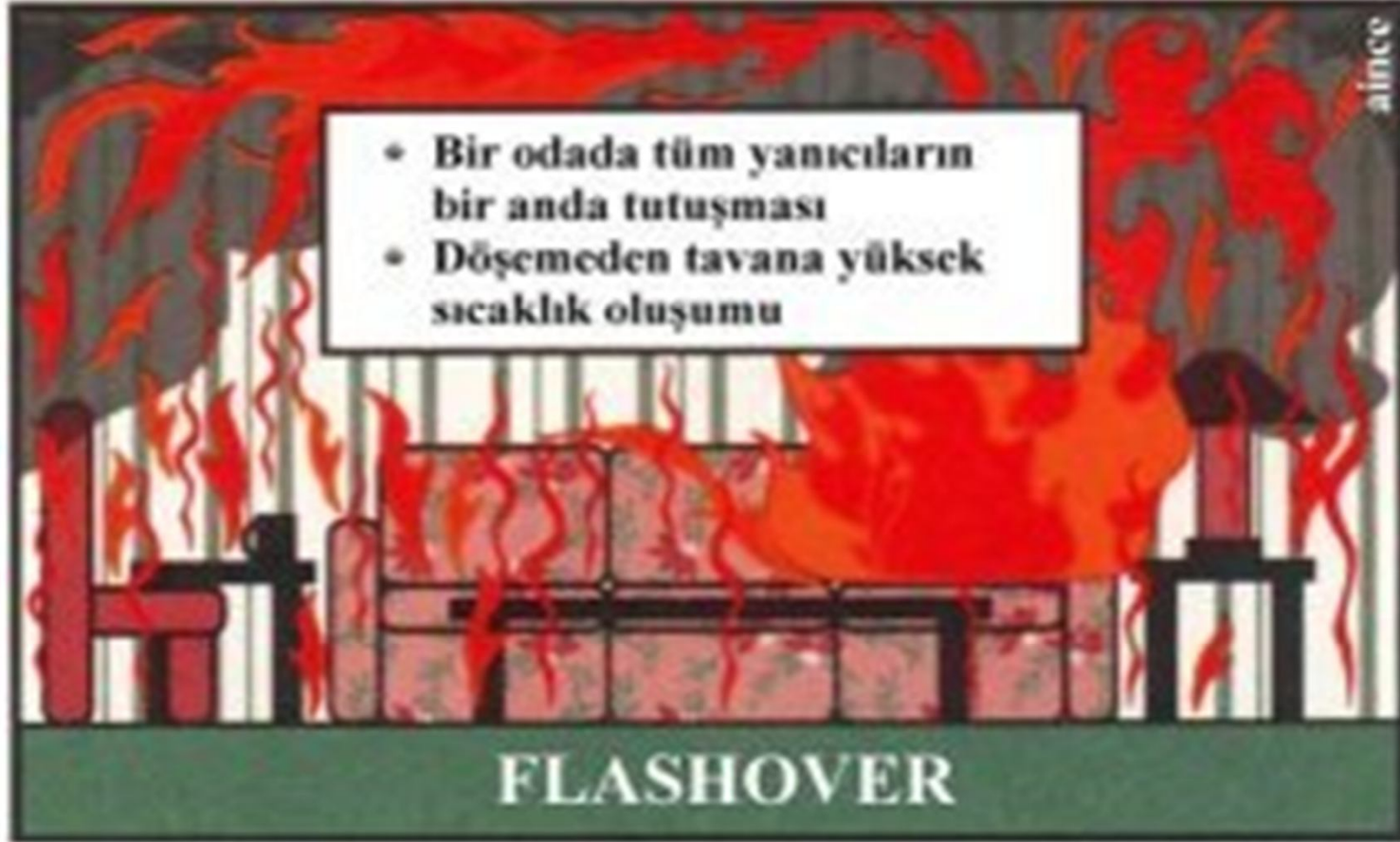
Şekil 10: Flashover olayında odadaki tüm yanıcı maddeler tutuşma sıcaklığına ulaşmıştır.
