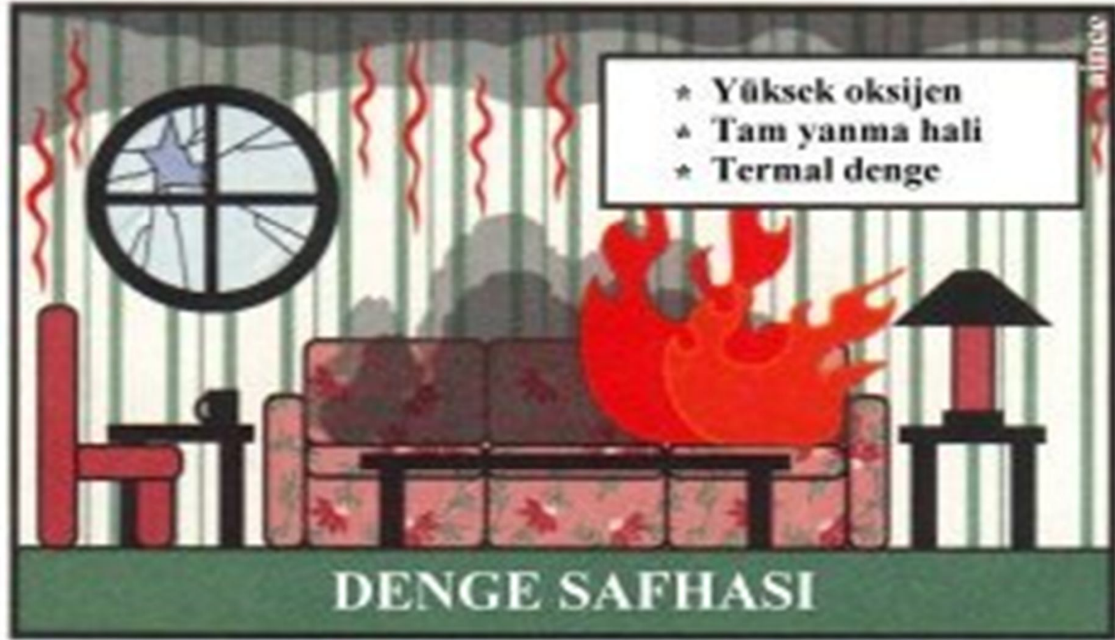
Şekil 9: Yanma periyodunun denge hali
