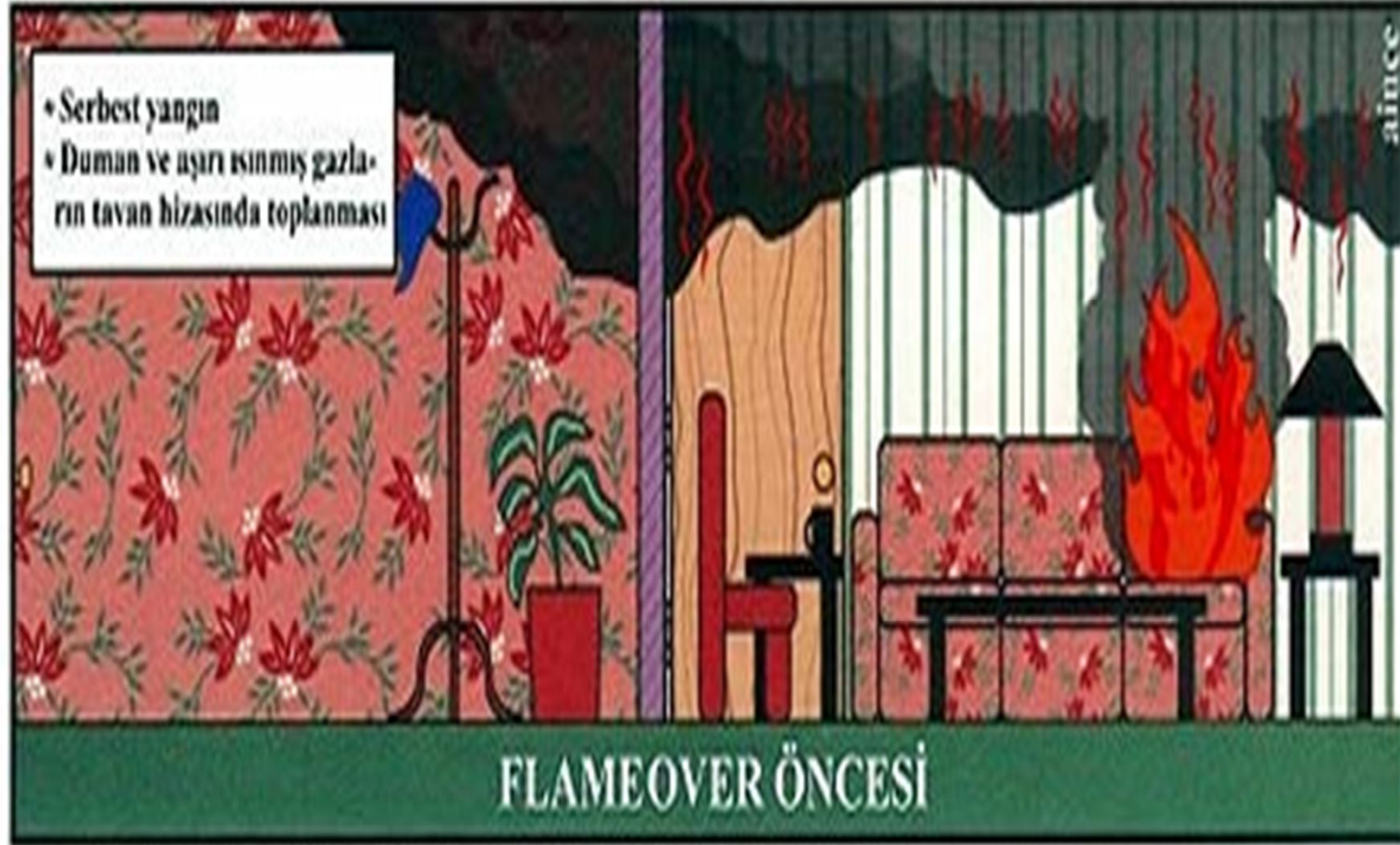
Şekil 7: Yarım yanmış gazlar tavan hizasında toplandığında Flameover öncesi durumu oluşur.
